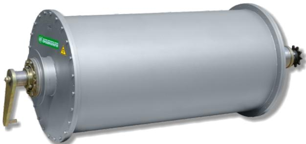
Внедрение барабана на предприятии АО «Казцинк» позволило увеличить эффективность извлечения утяжелителя (с ферросилицием), в результате чего достигнуто снижение его потерь с хвостами магнитной сепарации **в 3 раза**.
